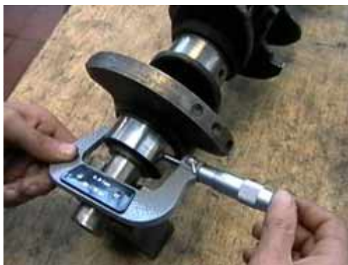
Mesure du diamètre du tourillon d'un vilebrequin
