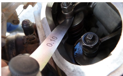
Image 12 Réglage du jeu aux soupapes
