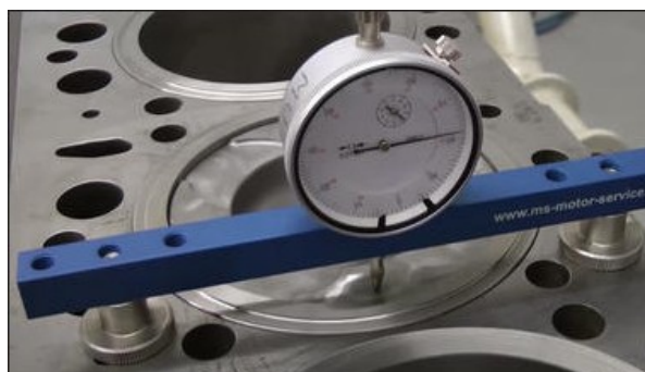
Mesure du dépassement du piston
