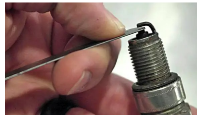
Image 11 Contrôle de l'écartement des électrodes d'une bougie
